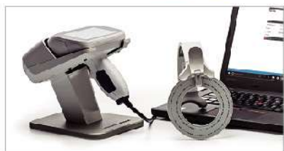
耳あなの形状を最新3Dスキャナーで撮影し、耳型を作る「オトスキャン」
